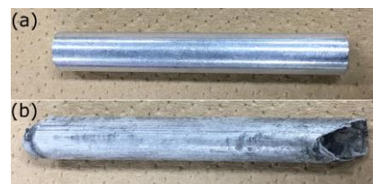
図 1 (a) ECAP 加工前と (b) ECAP 加工後の工業用純アルミニウム棒材
