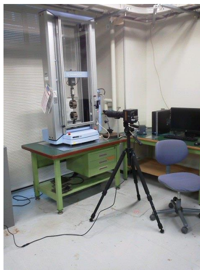
図 2 引張試験の高速カメラを用いた測定のセッティング。なお、3脚の上に固定されているのが高速カメラである。
